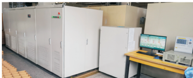
图12 交直流叠加加速老化试验平台
